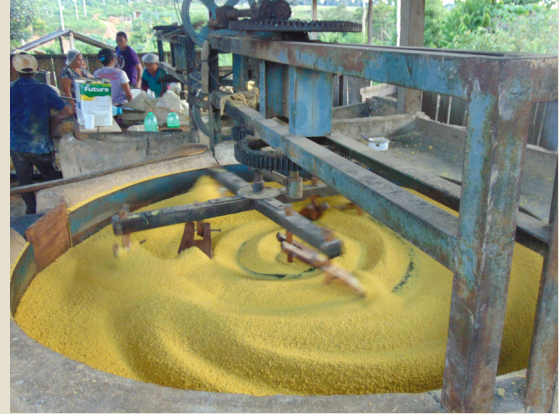
Fabricação de farinha com forno mecanizado
