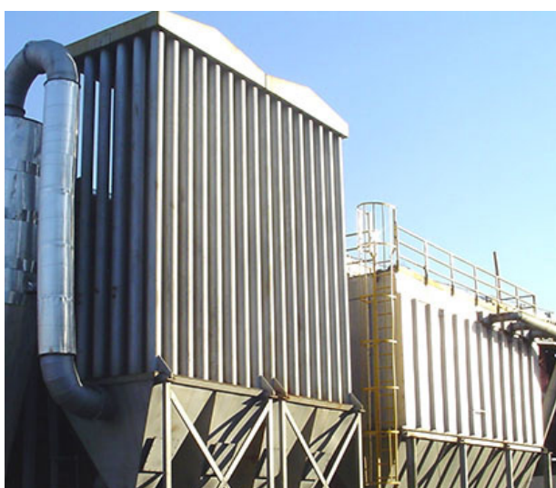
Exemplo de Filtro de Mangas utilizado para captação de pó.
