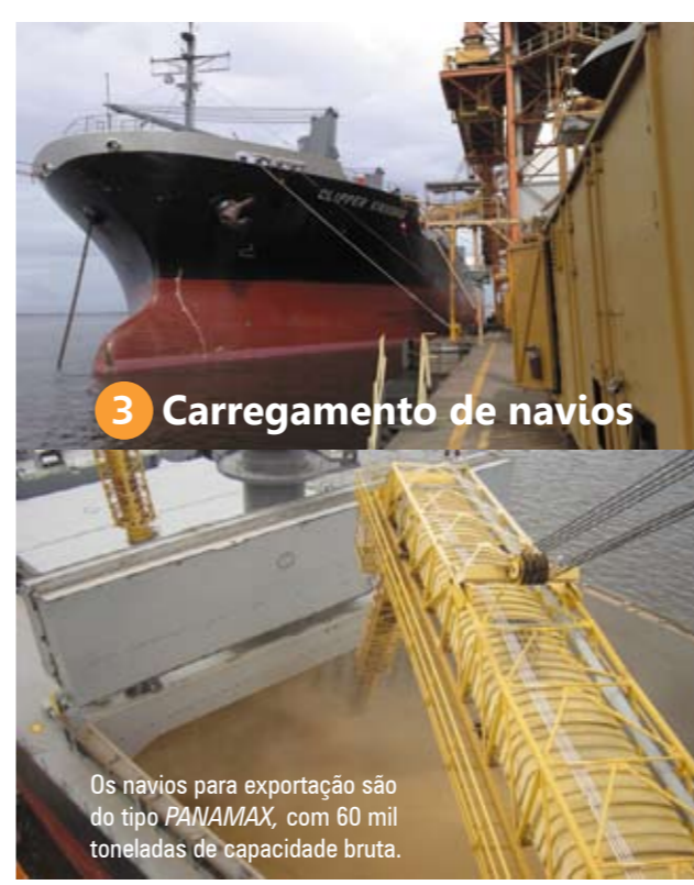
A soja segue do píer ao Terminal em correias enclausuradas para controle de poeiras e é pesada em balança de fluxo.
