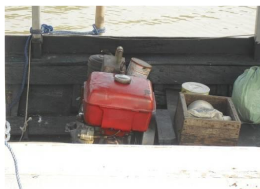
FOTO 29: MOTOR DE CENTRO A DIESEL USADA EM ALGUMAS EMBARCAÇÕES DE PESCADORES DE MIRITITUBA
