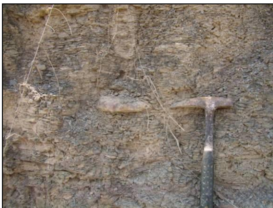
FOTO 4.2-6: Foliação plano paralela, observada no folhelho da formação curuá.
