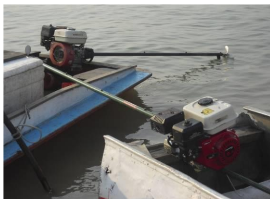
FOTO 27: MOTOR DO TIPO “RABETA” UTILIZADO COMO PROPULSOR NAS CANOAS DE MADEIRA PELOS PESCADORES DE MIRITITUBA, PARÁ.
