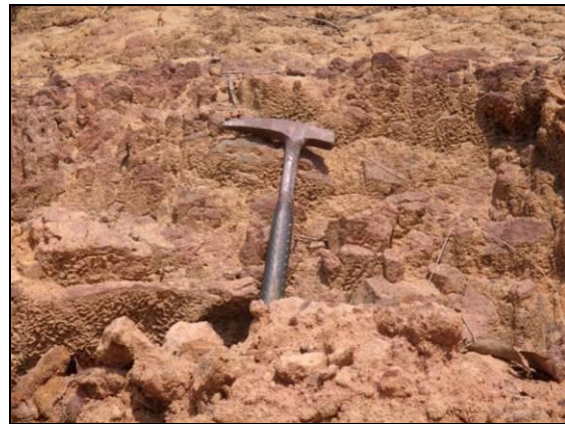
FOTO 4.2-9: Conglomerado ferruginoso, associado a solo argiloso, recoberto a formação Monte Alegre.
