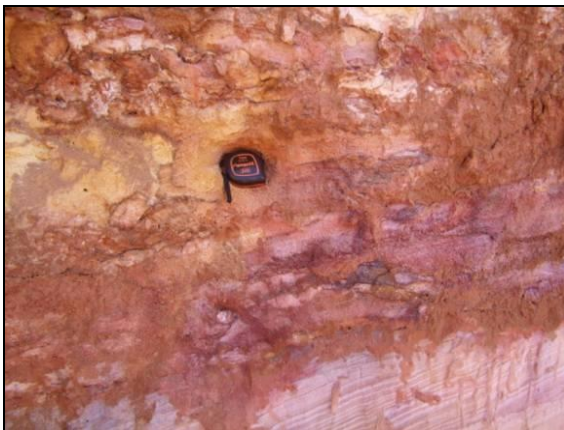
FOTO 4.2-3: Gradação de areia grossa, com níveis de concentração de ferro, para areia fina.
