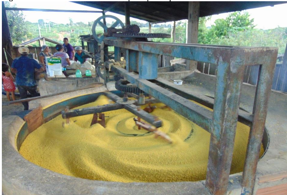
Figura 7.3.73 - Forno mecanizado para produção de farinha
