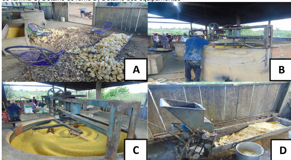
Figura 7.3.35 - Casa de farinha em sistema mecanizado A) Matéria-Prima B) Visão interna da casa de farinha C) Detalhe do forno D) Detalhe dos equipamentos
