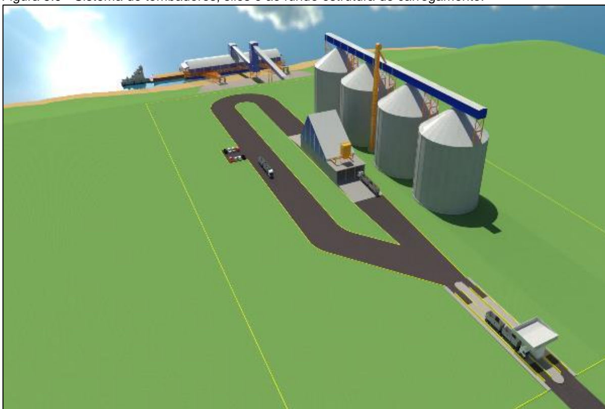
Figura 5.9 - Sistema de tombadores, silos e ao fundo estrutura de carregamento.
