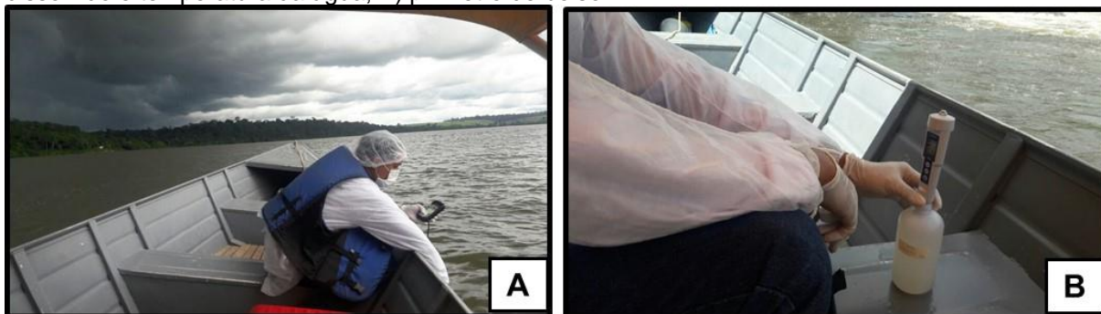
Figura 7.1.39 - Medição de parâmetros in loco A) medidor multiparâmetro que analisa oxigênio dissolvido e temperatura da água; B) pHmetro de bolso.
