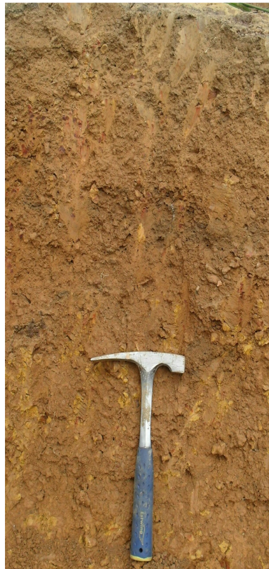
Plintossolo Pétrico Concrecionário Distrófico típico, utilizado como material para construção de estrada.
