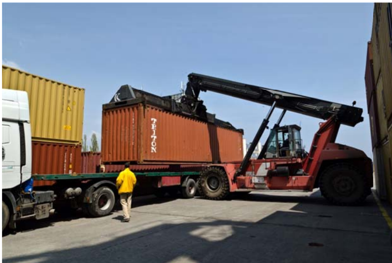
Figura 5. Modelo de empilhadeira reach stacker.
