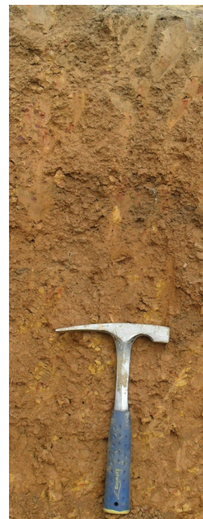
Plintossolo Pétrico Concrecionário Distrófico típico, utilizado como material para construção de estrada.
