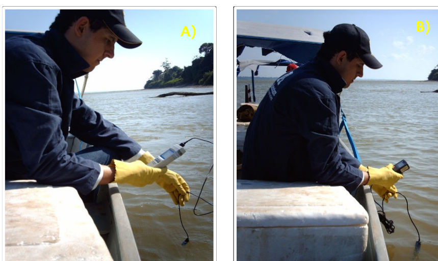
Figura 50. Medição in situ de pH (A) e oxigênio dissolvido (B).
