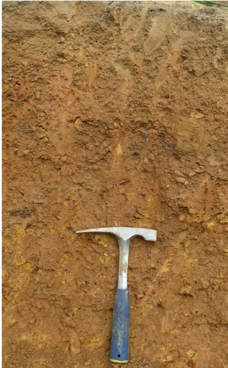
Figura 27. Perfil 2. Plintossolo Pétrico Concrecionário Distrófico típico, utilizado como material para construção de estrada.
