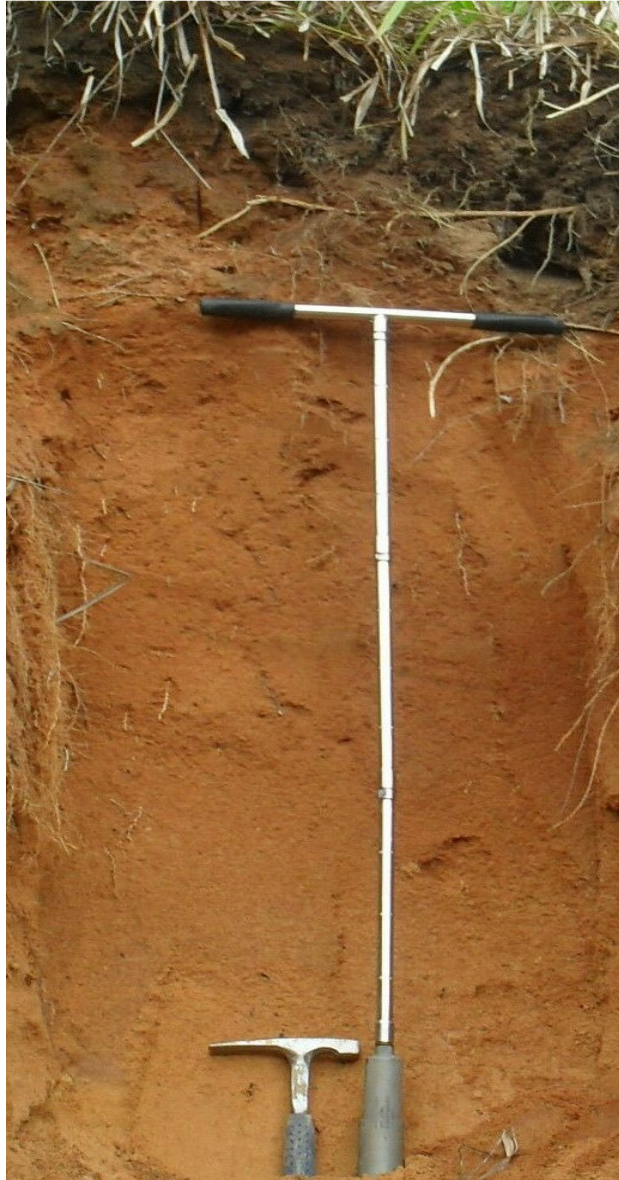
Figura 26. Perfil 1. Latossolo Amarelo Distrófico que ocorre na ADA tem textura arenosa e profundidade acima de 3 m.
