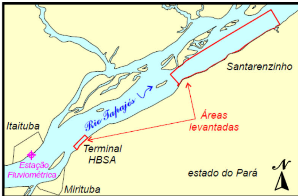
Figura 59: Localização das áreas onde foram realizados os levantamentos batimétricos.
