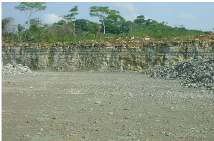
Figura 16: Extração de calcário pertencente a Formação Itaituba. Mina de localizada no município de Itaituba. Fonte: Eletronorte, 2008.
