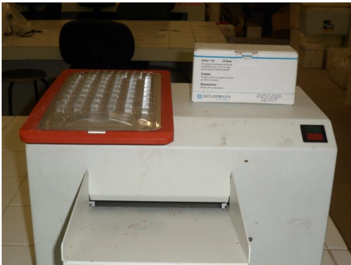
Figura 79: Seladora, cartela e substrato, utilizados para análises de coliforme total e termotolerante, método Colilert.
