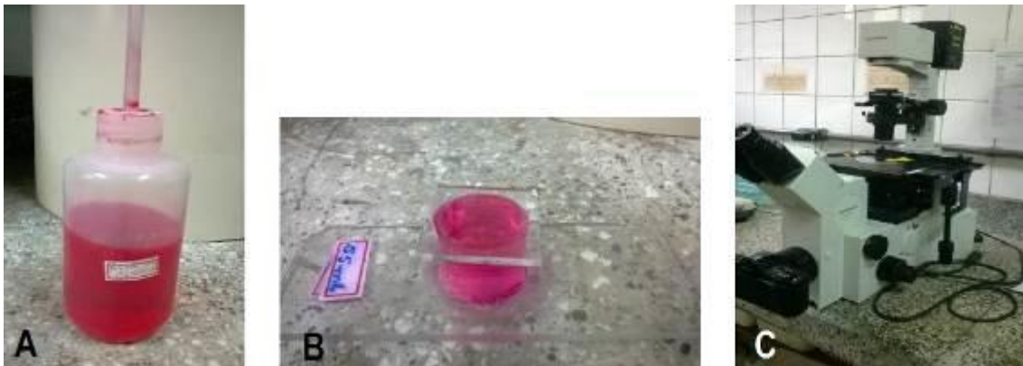
Figura 166: A: corante Rosa de bengala usado para corar os organismos presentes na cubeta de sedimentação; B:cubeta de sedimentação usada para análise quantitativa; C:Invertoscópio Olympus IX70 usado para a análise quantitativa de microfitoplâncton.
