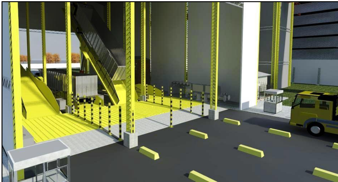
Figura 11: Acesso ao tombador de carretas
