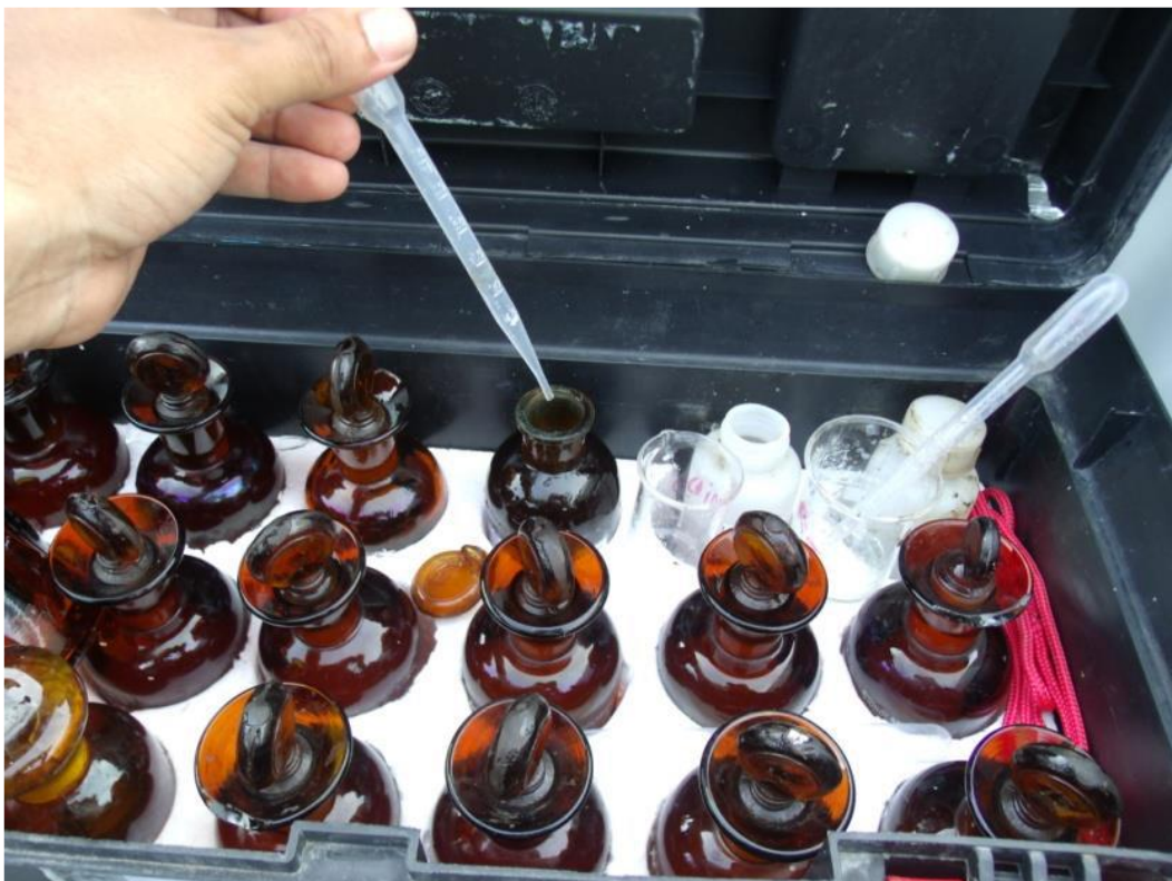
Figura 77: Amostras preservadas com iodeto alcalino de potássio e cloreto de manganês, para análise de OD.
