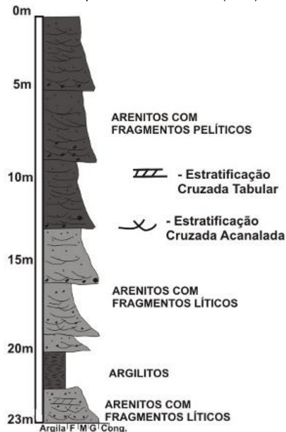
Figura 67 – Perfil Estratigráfico (caracterizando o aquífero livre) comum da Formação Alter do Chão.
