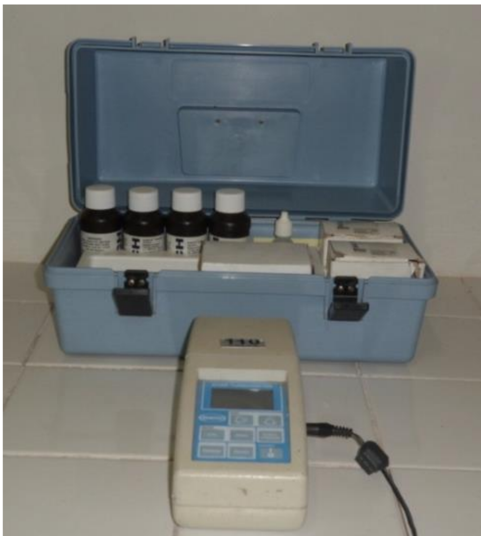
Figura 78: Turbidímetro da HACH, para determinação dos valores de turbidez das amostras de água.
