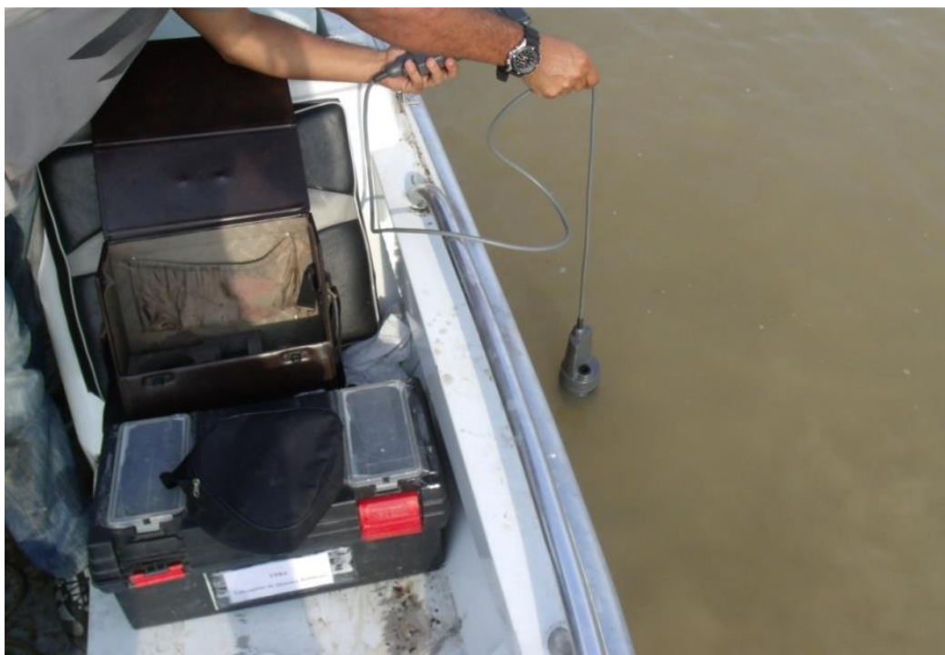
Figura 76: Utilização da sonda HANNA no momento da coleta.
