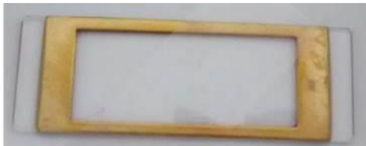
Figura 178. Câmara de Segdwich-Rafter utilizada para a determinação da densidade relativa.
