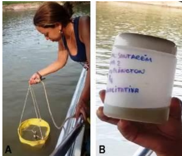
Figura 164: Coleta de amostra do microfitoplâncton: A: rede de plâncton; B: frasco de polietileno.
