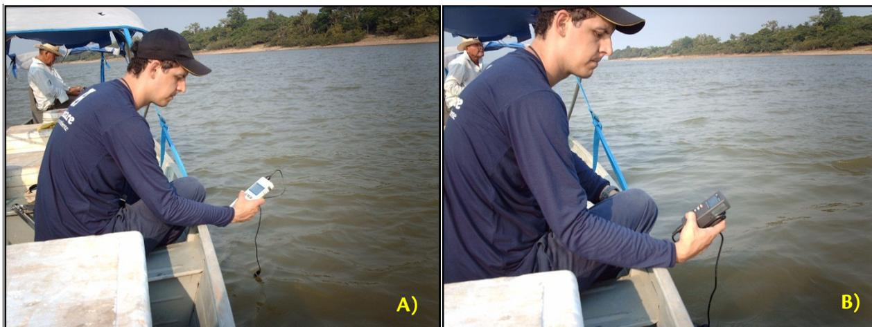
Figura 37. Medição in situ de pH (A) e oxigênio dissolvido (B).
