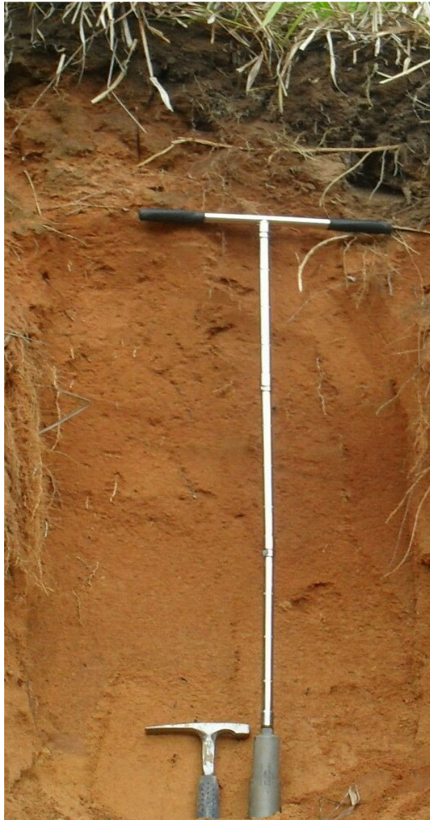
Figura 28. Perfil 1. Latossolo Amarelo Distrófico que ocorre na ADA tem textura arenosa e profundidade acima de 3 m.
