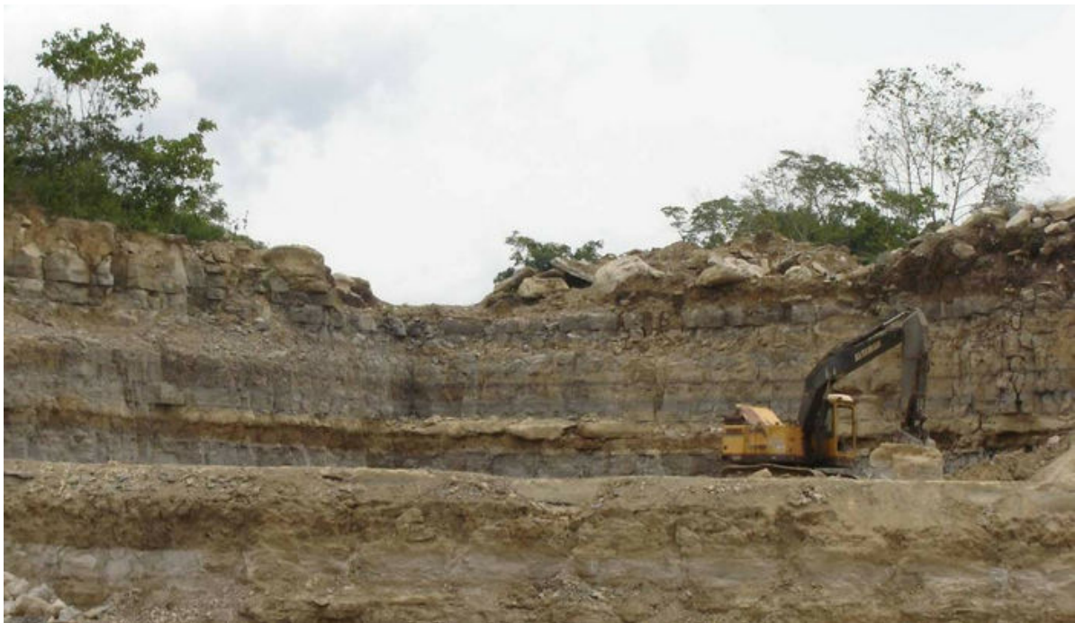
Figura 18. Extração de calcário na mina pertencente a Calminas localizada no município de Itaituba.
