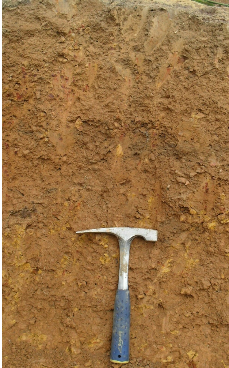
Figura 29. Perfil 2. Plintossolo Pétrico Concrecionário Distrófico típico, utilizado como material para construção de estrada.
