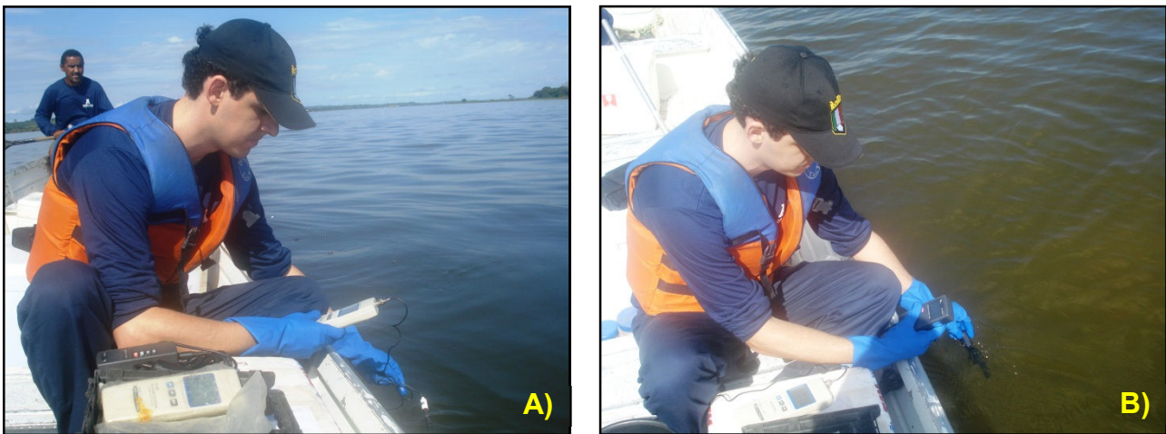
Figura 42. Medição in situ de condutividade elétrica (A) e oxigênio dissolvido (B).
