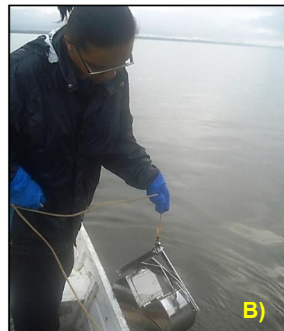
Figura 46. Coleta de zoobentos com amostrador “Dip net” (A) e com draga “Petit ponar” (B).
