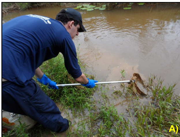
Figura 46. Coleta de zoobentos com amostrador “Dip net” (A) e com draga “Petit ponar” (B).
